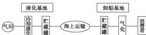
图7 液化天然气输送线路示意图
